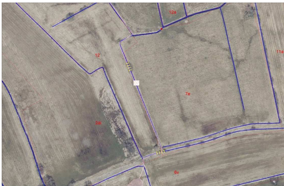
Figur 10. Oversigtlig angivelse af 2 strækninger/områder, hvor der ryddes (gul markering) i forbindelse med omlægning af drænsystem D7. Der skal foretages
