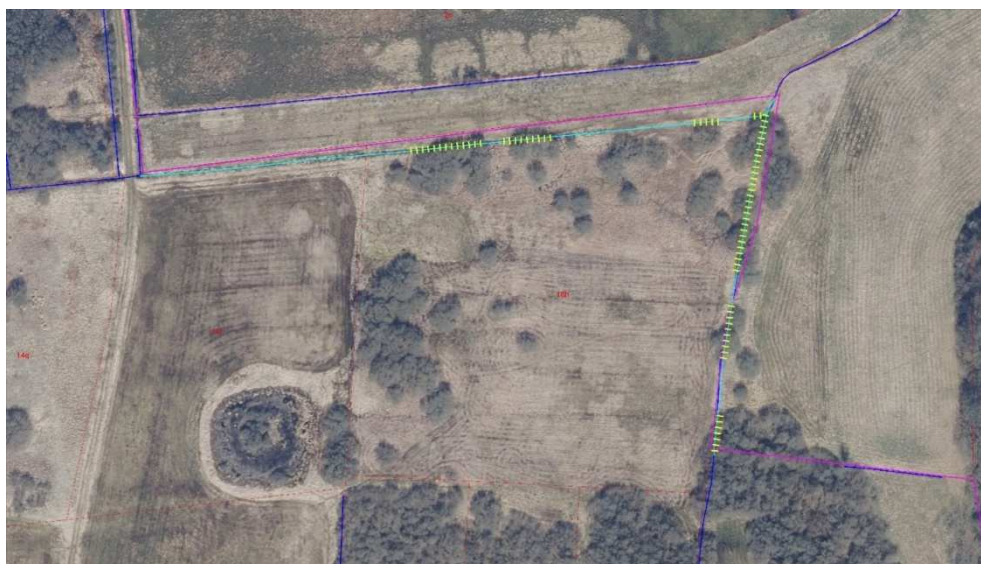
Figur 8. Oversigtlig angivelse af strækninger/områder med buske og mindre trævækst, der ryddes (gul, grøn markering) ved etablering af afskærende grøft omkring matr.nr. 16h, Kvorning By, Kvorning. Der skal påregnes rydninger (gul og grøn streg) af løvbuske i forskellige størrelser. Samlet set forventes en rydning af
