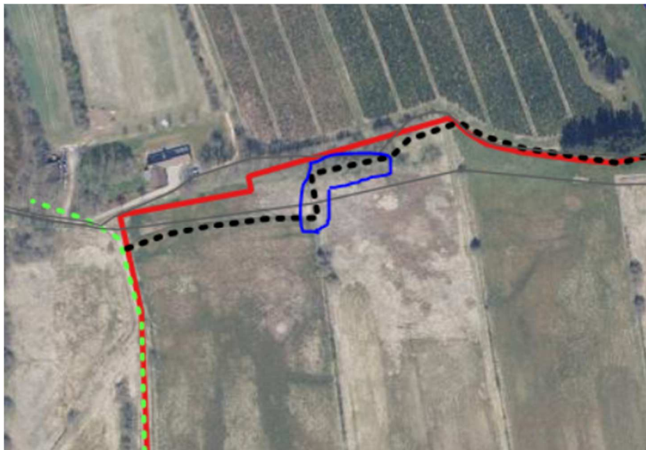
Figur 39: Placering af 75 m lang bordwalk i projektområdets nordvestlige hjørne. Projektgrænse (rød streg), ny trampesti (sort stiptet linje), boardwalk (blå markering).
