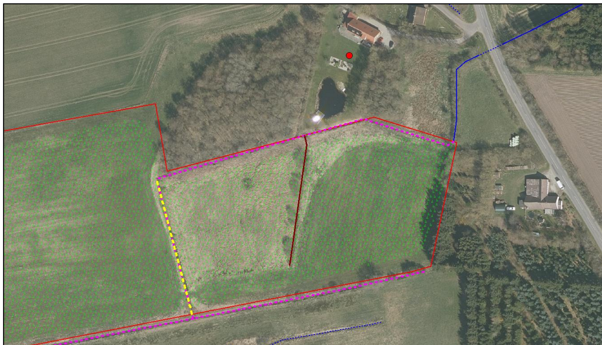
Figur 8-7. Eksisterende grøfter (lilla) bevares. 1 grøft (gul) rørlægges.
