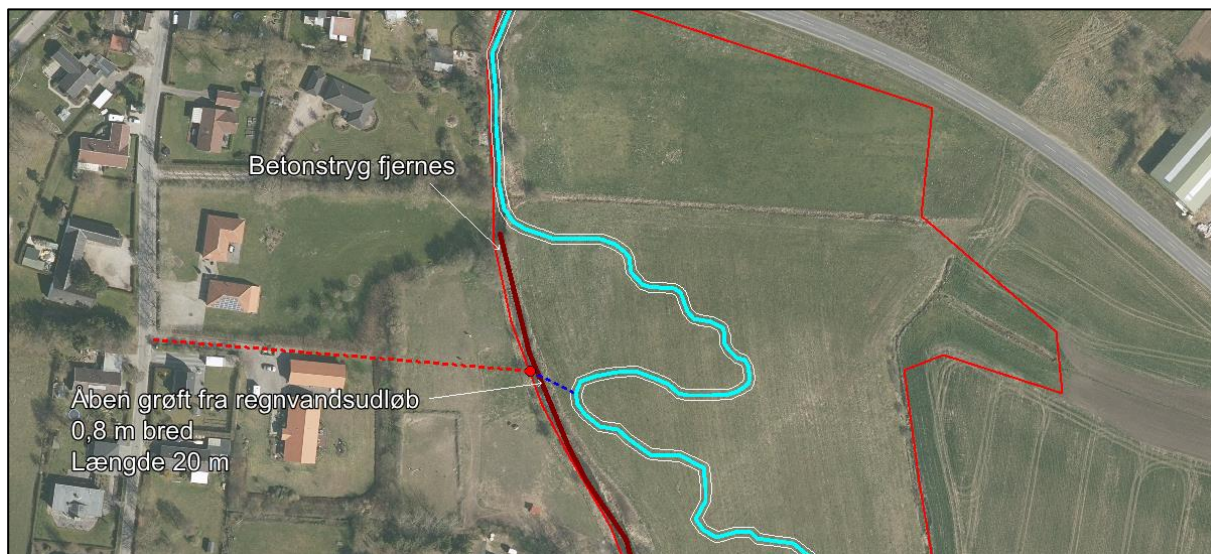
Figur 8-5. Regnvandsoverløb og ny grøft ved Bjerregrav.
