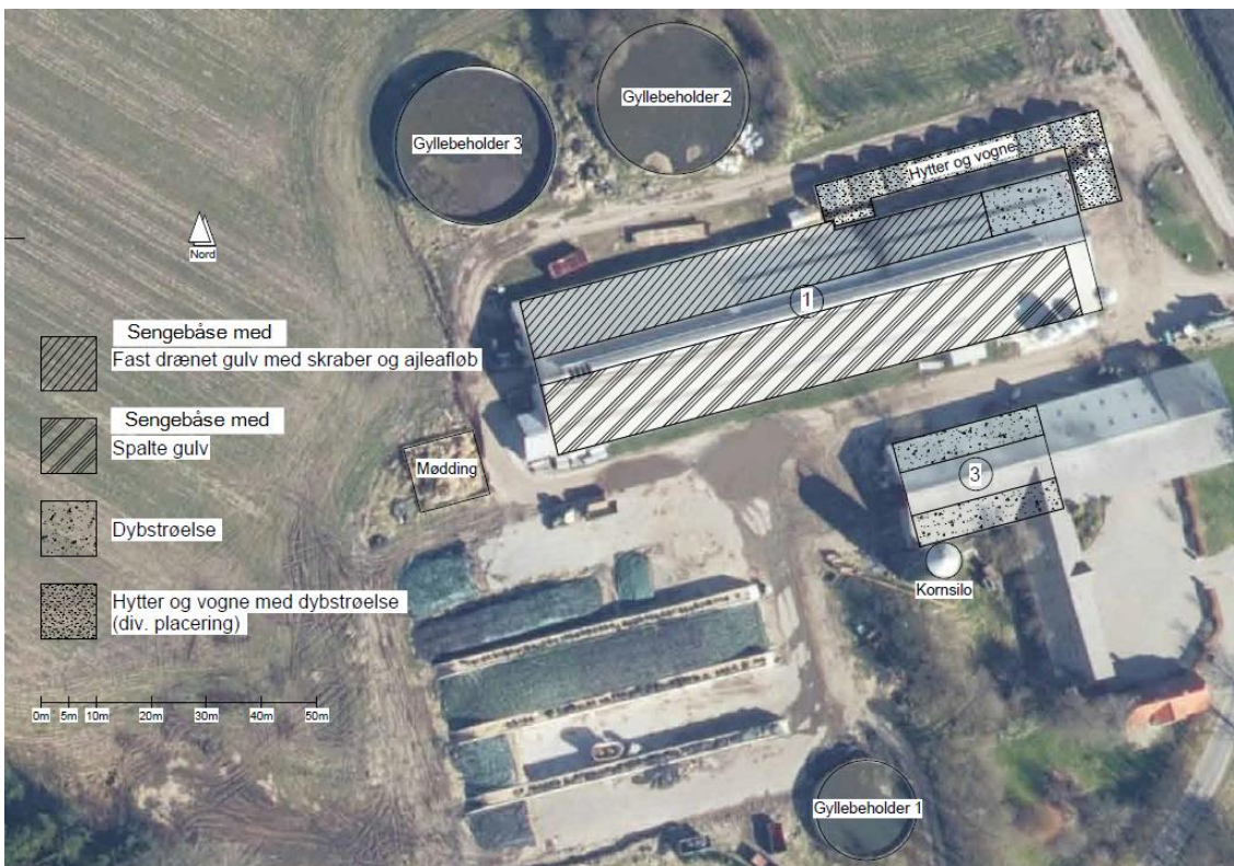
Figur 2 Viser de ansøgte gulvtyper i de forskellige staldafsnit
