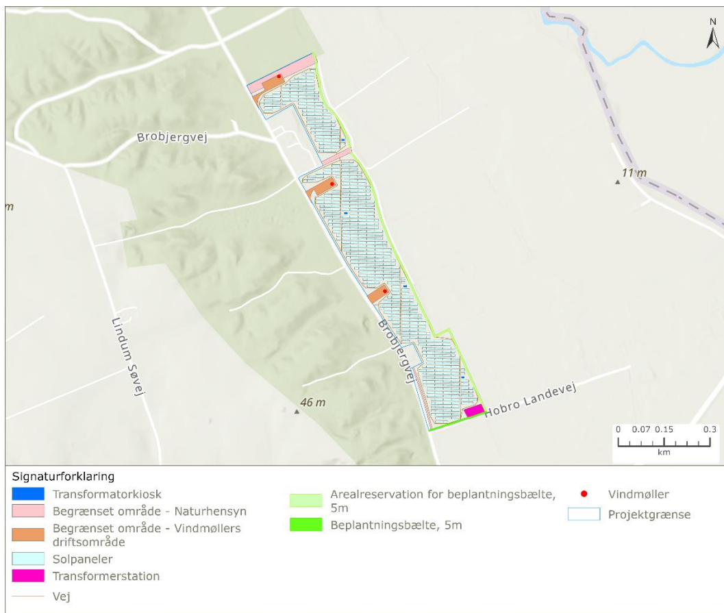
Figur 3-4. Projektområdets indretning med arealer til solceller på faste stativer.
