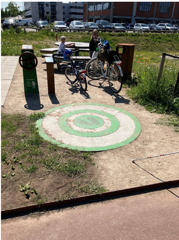
Billede 4, billede af opholdsplads, hvor der er en høj kant fra stien, der gør den utilgængelig.
