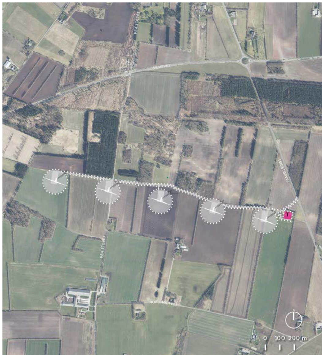
Figur 5.5: Oversigtskort der viser det samlede vindmølleprojekt. Pink flade viser hvor stepup transformeren kan placeres inden for plan- og projektområdet.
