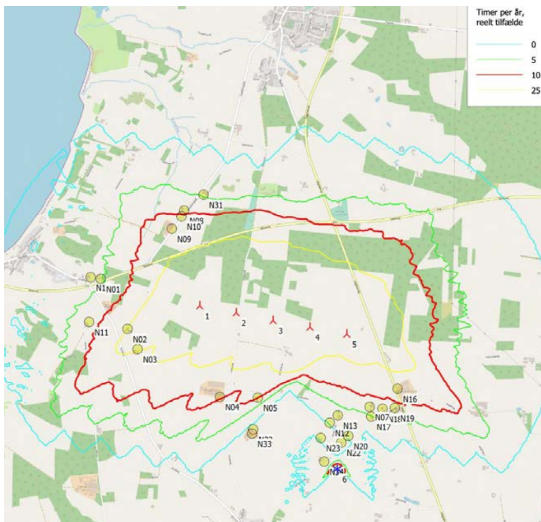
Figur 7.4 Oversigtskort med beregnede skyggekastværdier fra et projekt baseret på Vestas vindmøller, set i forhold til de omkringliggende naboboliger. Rød linje viser de punkter hvor det årlige skyggekast er 10 timer. Grøn linje viser de punkter hvor det årlige skyggekast er 5 timer, mens blå linjer viser hvor skyggekastet er 0
